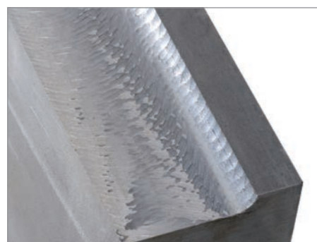
Asportazione elevata del truciolo senza ACC
