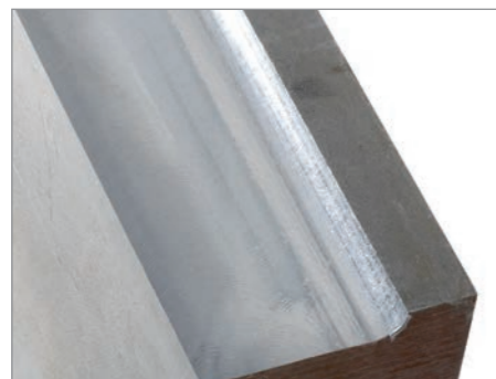
Asportazione elevata del truciolo con ACC
