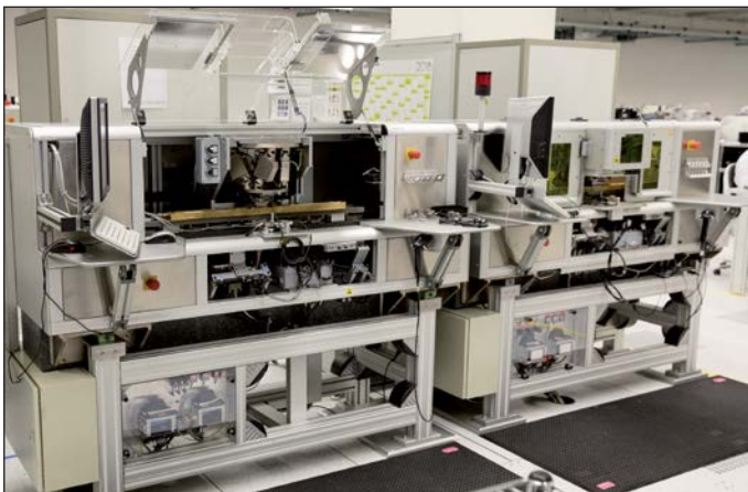
Figura 10: su una speciale stazione di misura l'errore di interpolazione viene determinato per ciascun sistema di misura lineare aperto calibrando la testina di scansione.
