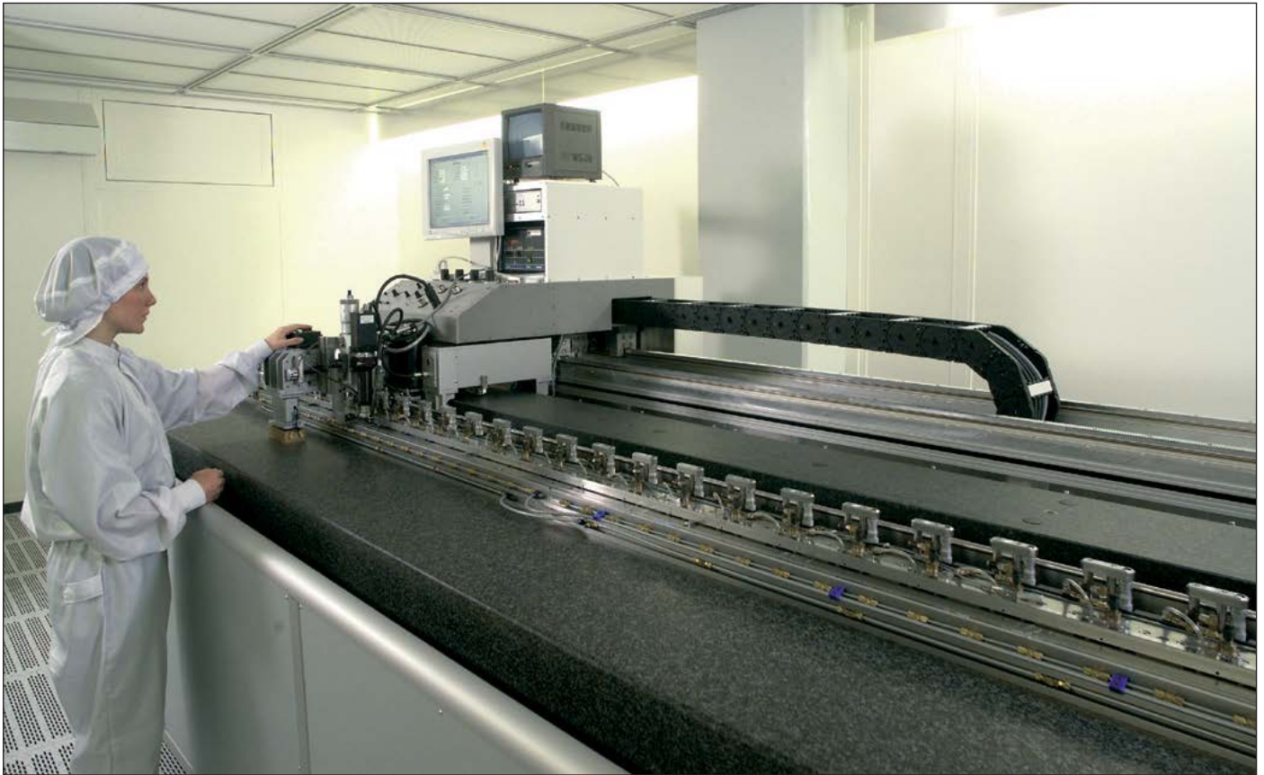
Figura 9: per ogni riga graduata di un sistema di misura lineare aperto, HEIDENHAIN determina l'errore base nell'intervallo definito utilizzando una macchina di misura speciale.
