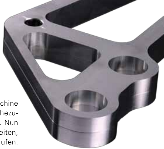
Deutlich sichtbar durch die Doppelbearbeitung: Die aus der Erwärmung des Kugelgewindetriebs resultierende Abweichung von 70 \mu\text{m}
