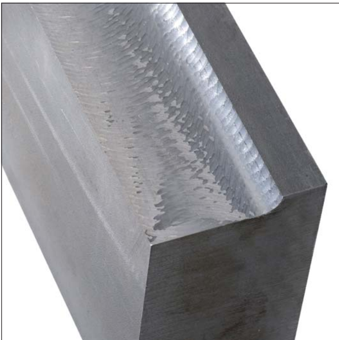
Pièce fraisée sans fonction ACC : les marques laissées par les vibrations sont clairement visibles.
