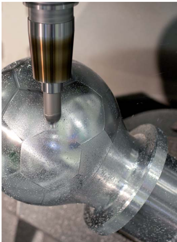
Produzione a 5 assi del pallone "Telstar" dei campionati mondiali del 1970 e 1974
