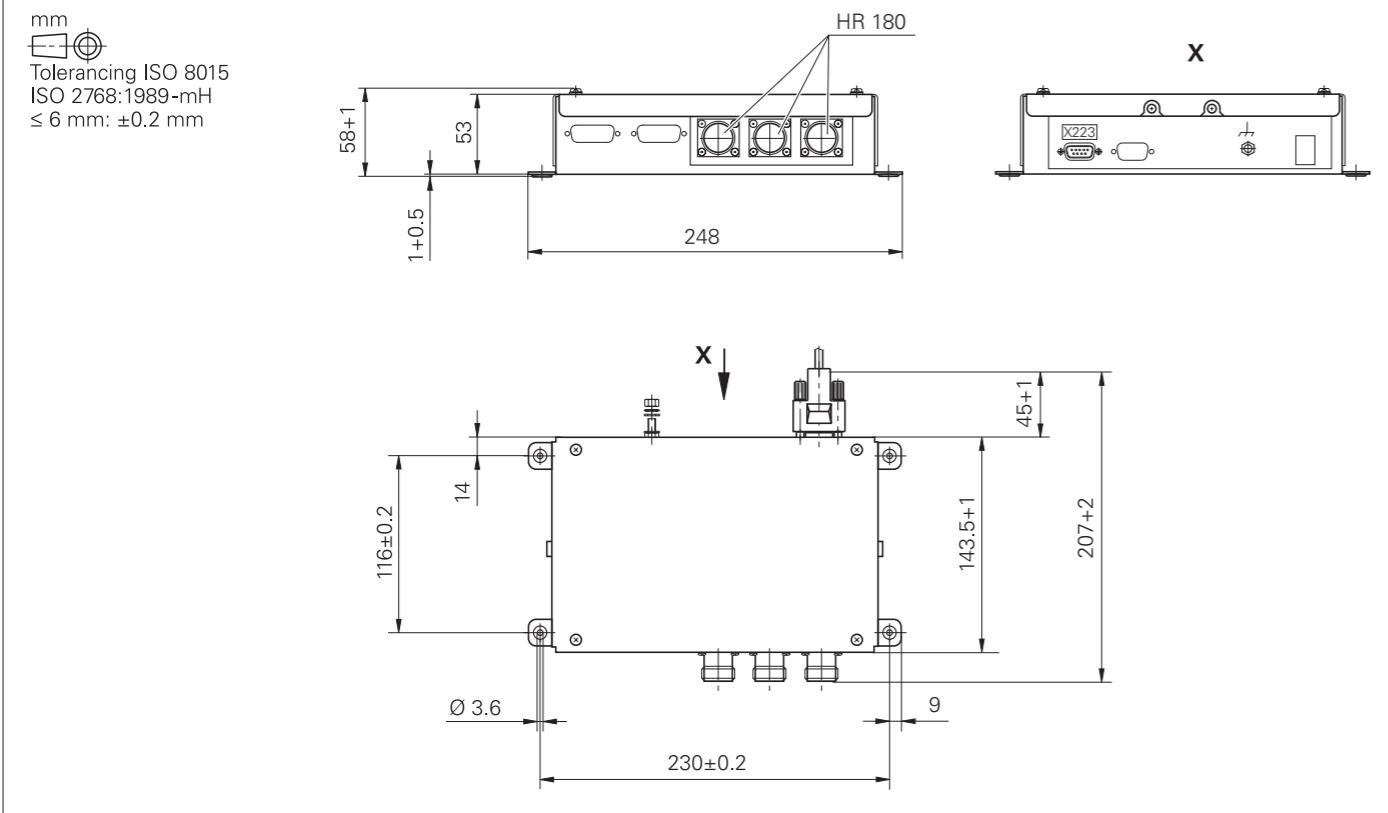
手轮适配电缆（直接头）
