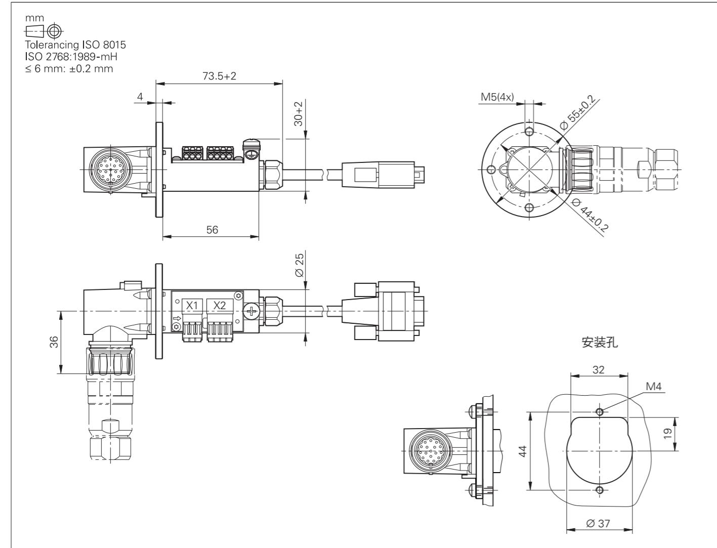
HR/HRA连接MC的适配电缆 (直角接头)
