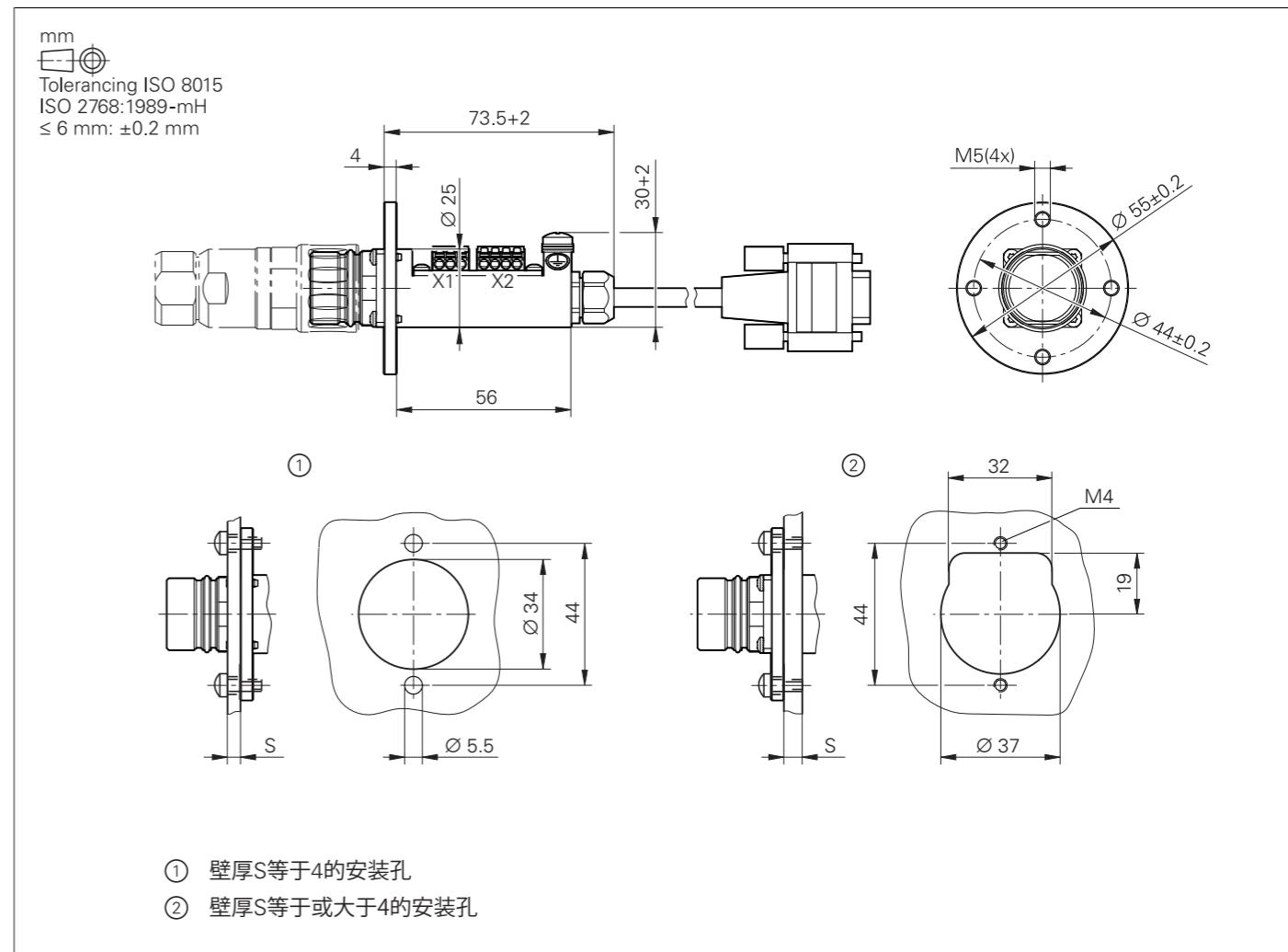
连接MC的HR/HRA适配电缆（直接头）
