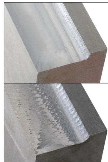
上图：用ACC功能铣削的零件
