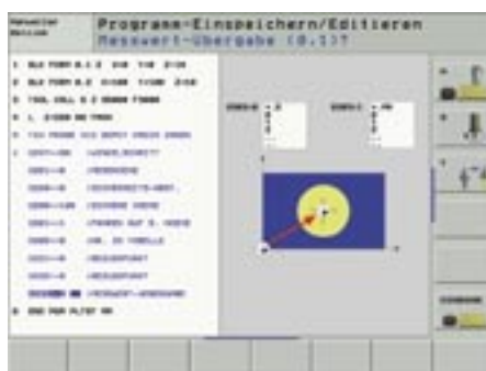
Bild 3: Antastzyklus mit Wertübergabe an die Preset-Tabelle
