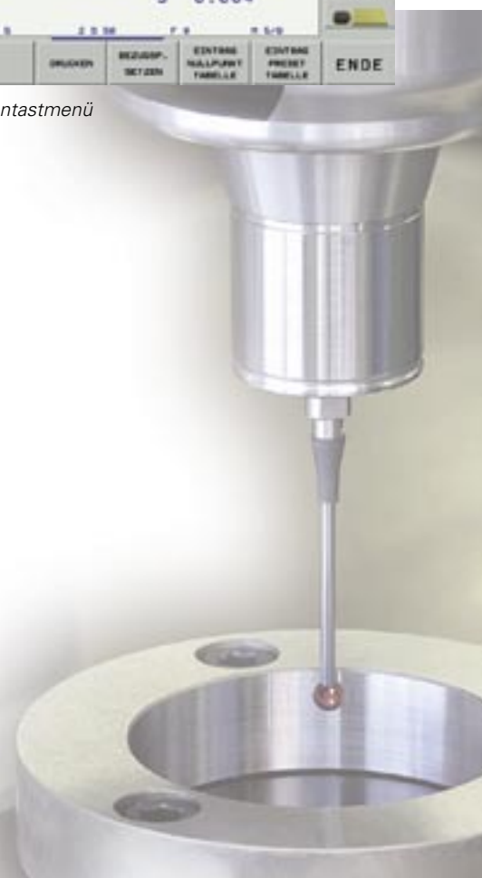
Bild 3: Antastzyklus mit Wertübergabe an die Preset-Tabelle
